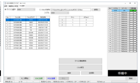
【データ回収 (CSV保存)】 記録媒体に保存されているバイナリデータをテキストデータへ変換します。 ※センサ生データや解析結果(姿勢角)を出力
